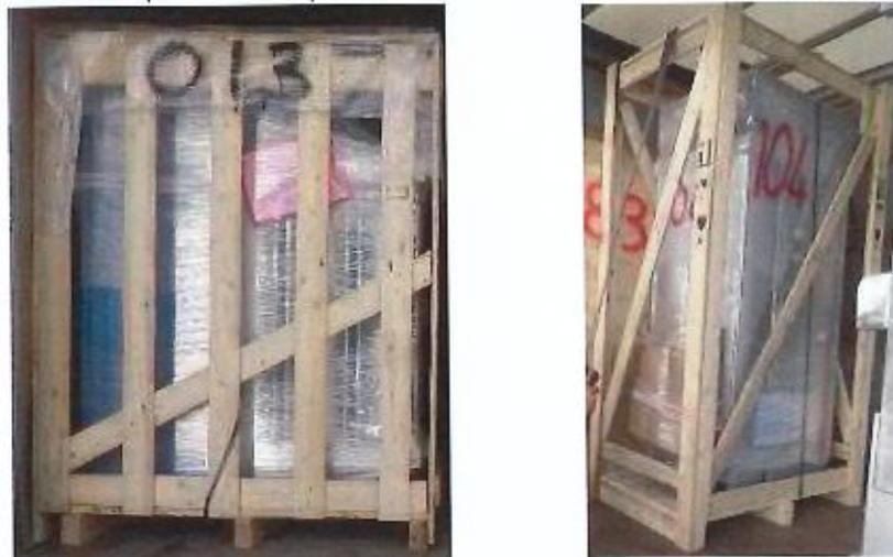
**Figura 35 Vecchia tipologia di gabbia (sinistra) e low cost (destra)**
